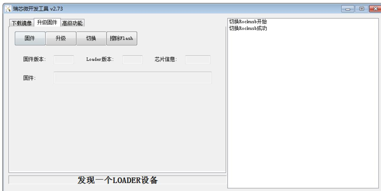
方式一、将设备接通电源，进入安卓系统，用 MicroUSB 线将设备与 PC 机连接好如下图，RKDevTool 软件会识别到一个 ADB 设备，单击切换按钮，设备会重启进入烧写模式
