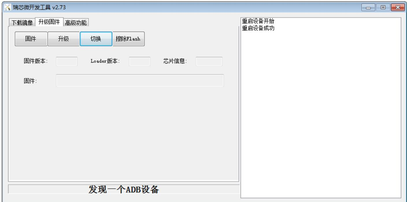
方式二、将设备断电，首先用 MicroUSB 线将设备与 PC 机连接好，按下设备的牙签孔按键，并保持按下状态，然后再上电开机，烧写软件检测到 LOADER 设备，松开牙签孔按键。
