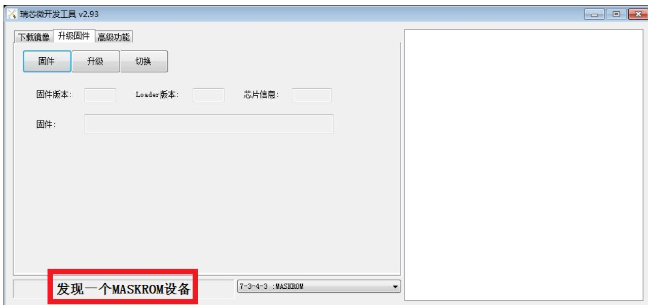
一般仅在 uboot 损坏，无法进入 Loader 模式时使用。将主板断电，首先用 TYPE-C 线将主板与 PC 机连接好，按下主板上的 SW2 ROM 键，并保持按下状态，然后再上电开机，主板会进入 MaskRom 操作模式，然后松开按键烧写系统即可。
