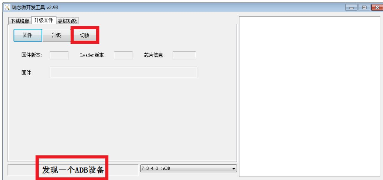
方式三、在调试串口控制台或其他控制终端输入 reboot loader，主板会重启进入 Loader 模式
