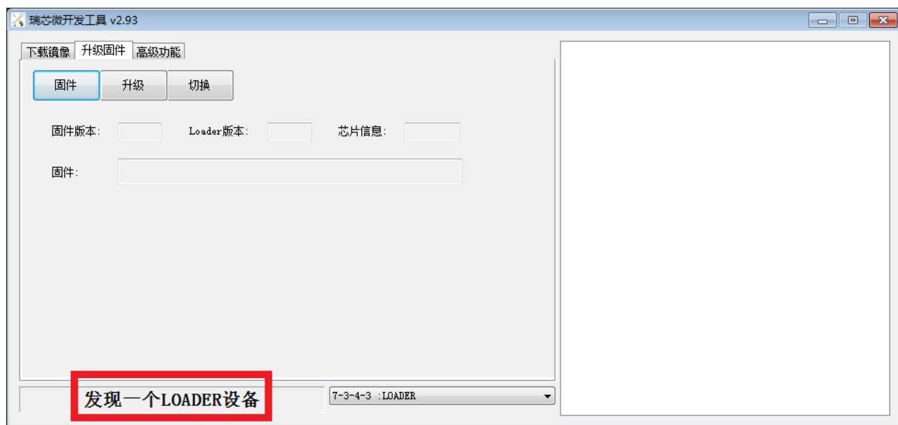
**方式一、**将主板断电，首先用 TYPE-C 线将主板与 PC 机连接好，按下主板上 SW1 烧写键，并保持按下状态，然后再上电开机，主板会进入 Loader 操作模式，注意这种方式适用于主板上的 BootLoader 可正常工作的情况。
